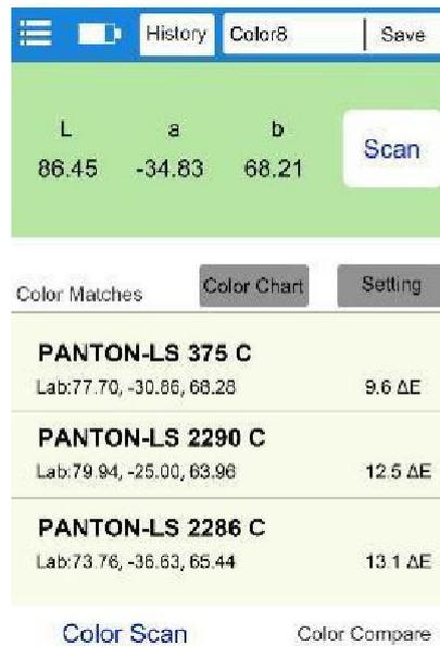
Datos de muestra: Después de la exploración, el área del botón de exploración mostrará los datos de color. . El usuario puede establecer el tipo de datos en Configuración.
